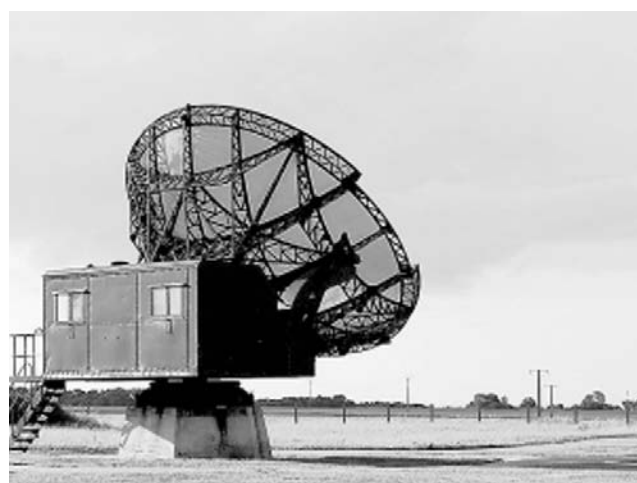
Paraboliczna antena radaru Würzburg (1943)
