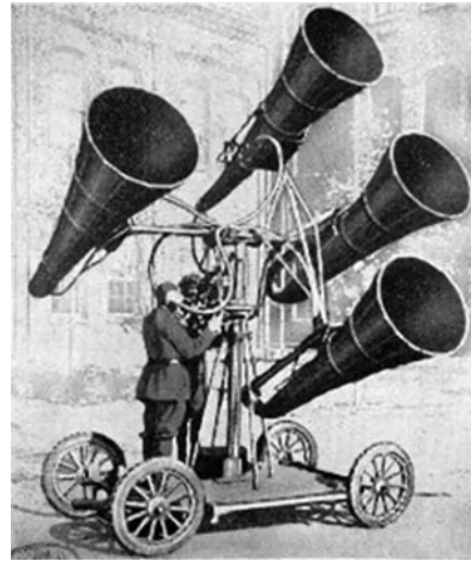
Jak podsłuchiwać sąsiadów? Brytyjski nastuchownik akustyczny, wczesne lata 30te XX wieku
